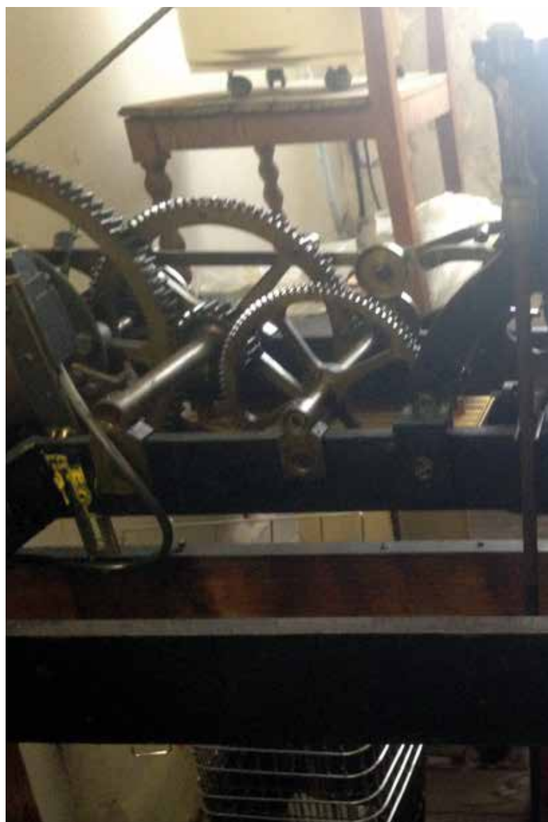
Imágenes del mecanismo (luego motorizado) del reloj de la casa consistorial.
