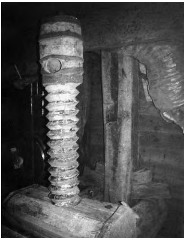
Lagar de tres usillos de madera del caserío Azkonobieta. (Urnietta).
