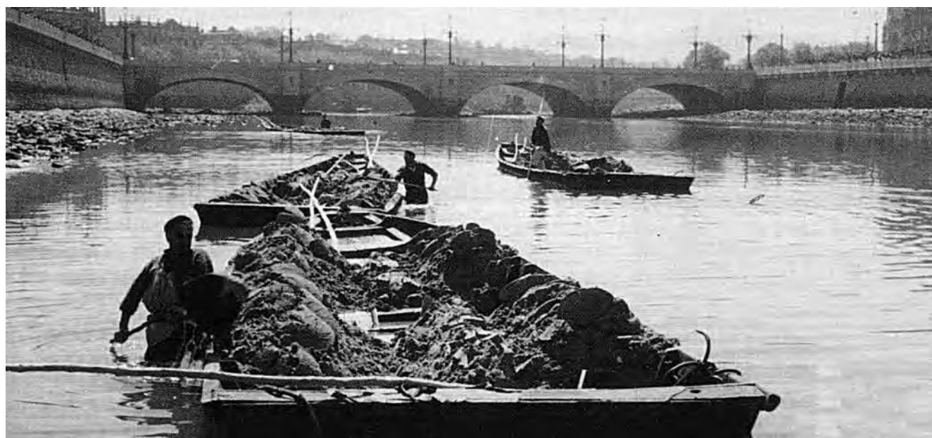
Las gabarras eran embarcaciones sin quilla, de fondo plano, que se utilizaban habitualmente para el transporte de mercancías.
