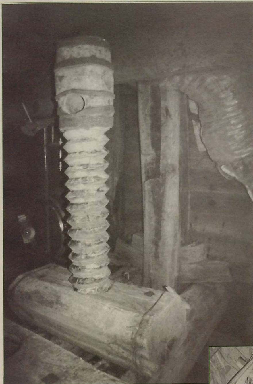
Lagar de tres usillos de madera del caserío Azkonobieta (Urnieta).
