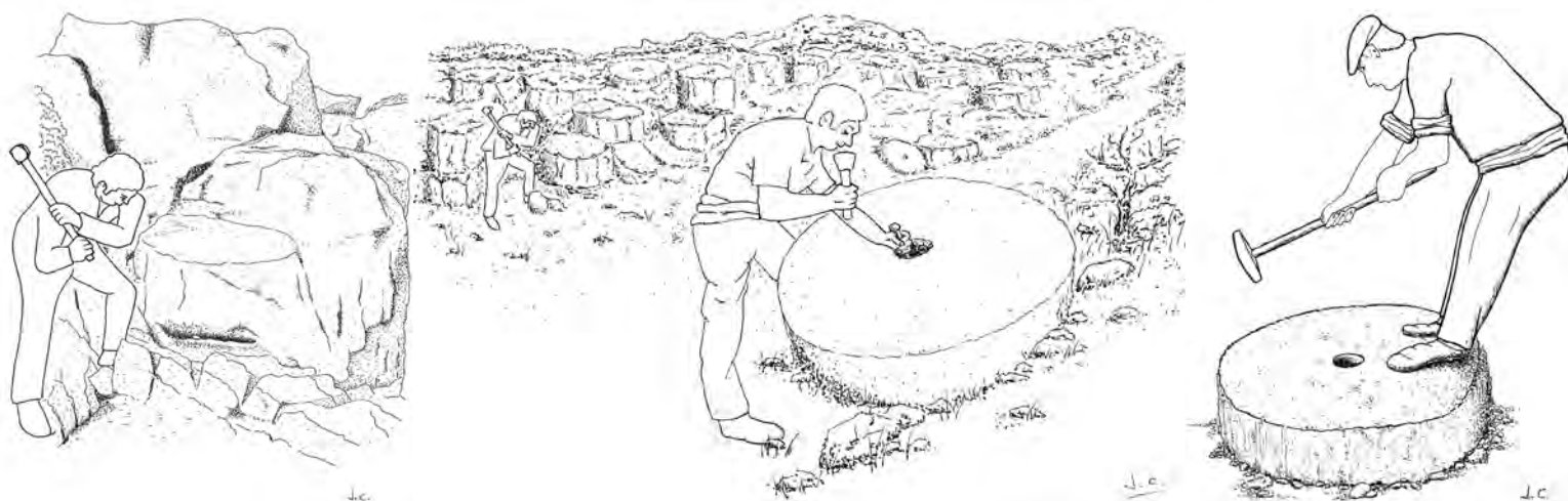
Extracción de roca mediante golpe con herramienta. Trabajo en una cantera molera, y tallado sobre la piedra.
